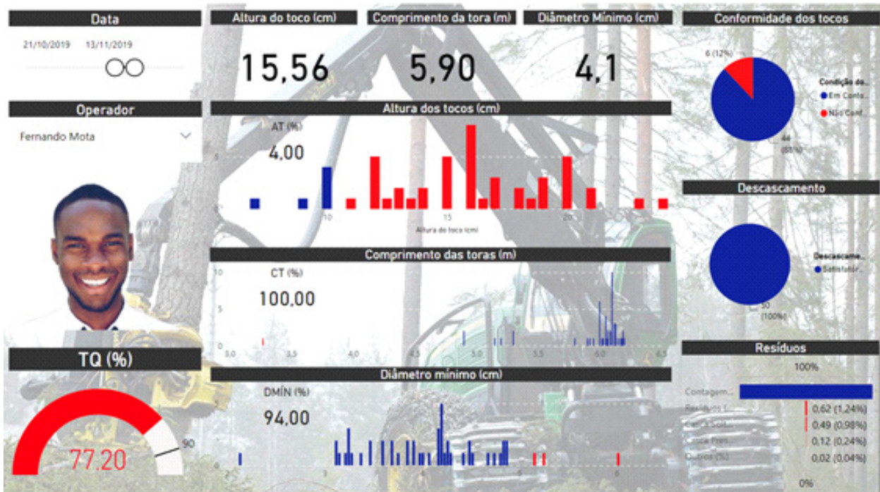
Figura 2 – Dashboard – Controle dos indicadores de qualidade da operação de corte florestal com harvester (Imagem do operador meramente ilustrativa).
